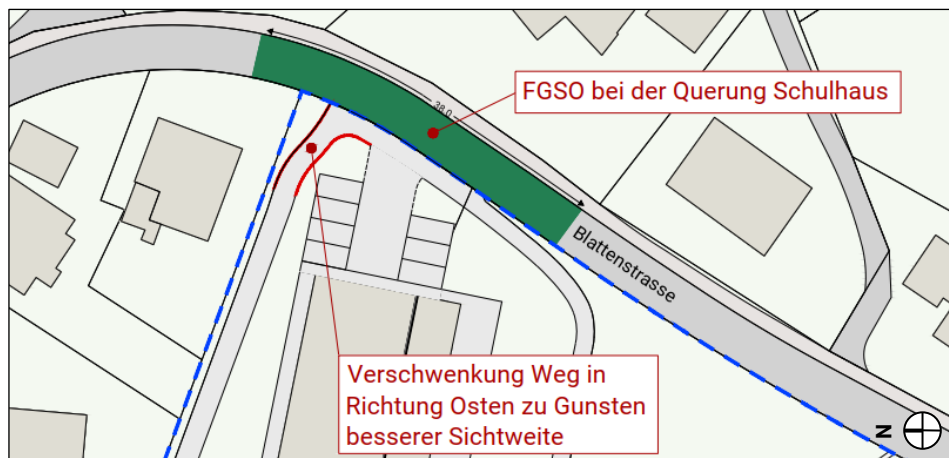
Abb. 31: Ausschnitt Massnahmenplan, Querung Schulhaus nach der Schulraumerweiterung mit FGSO, Quelle: R+K
