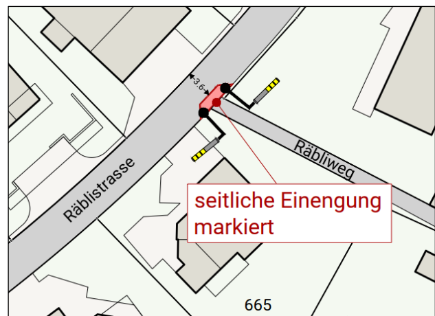
Abb. 33: Ausschnitt Massnahmenplan mit Querungshilfe Rächlistrasse, Quelle: R+K
