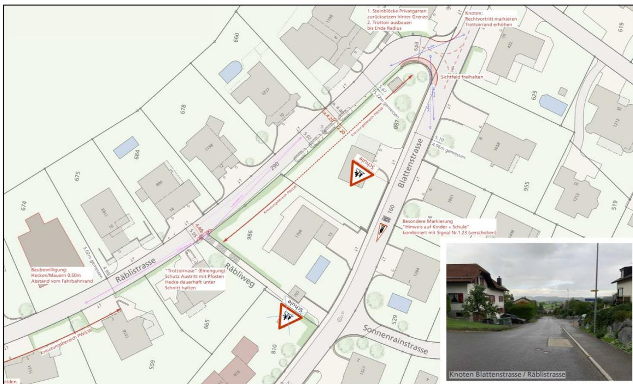
Abb. 30: Ausschnitt Massnahmenkonzept Verkehrssicherheitskonzept Räblistrasse, Quelle: asa AG, 25.11.2022
