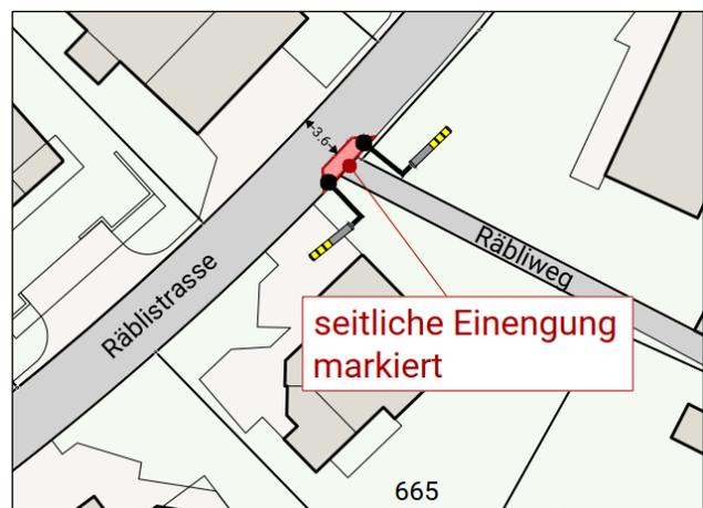
**Abb. 33:** Ausschnitt Massnahmenplan mit Querungshilfe Räßlistrasse, Quelle: R+K
