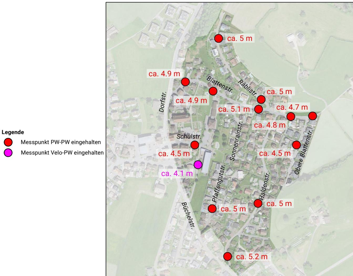
Abb. 10: Strassenbreiten im Perimeter, Darstellung: R+K, Quelle Luftbild und Messdaten: GIS-SG
